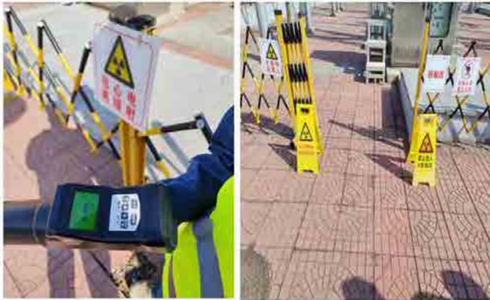
(4) 该探伤机工作时间结束后，用辐射监测仪检测周边，观察报警仪是否还发出警报声，确认未出现以上情况，进入戒区域，靠近机器检查并排除故障。
