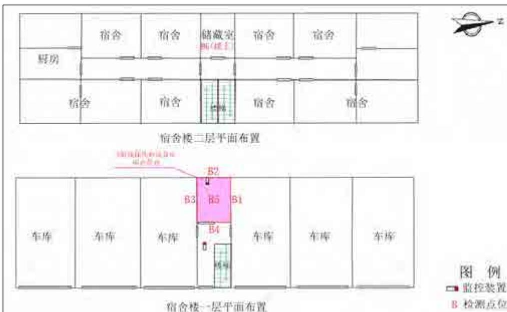
图 6-2(a) X 射线探伤机设备库周围监测点位示意图
