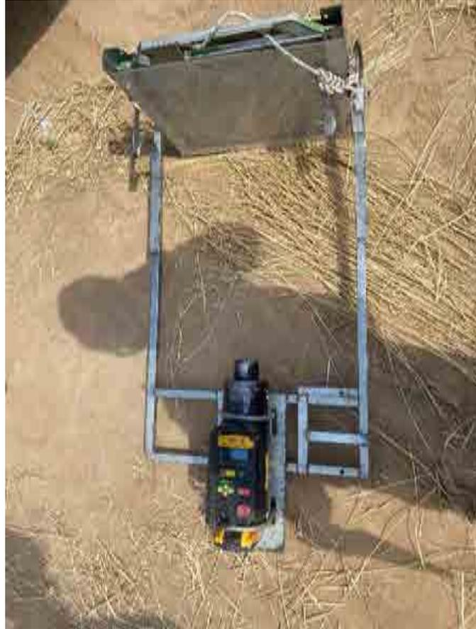
图 2-3 本项目 SMARTRAD 3543 型工业 X 射线探伤机照片
