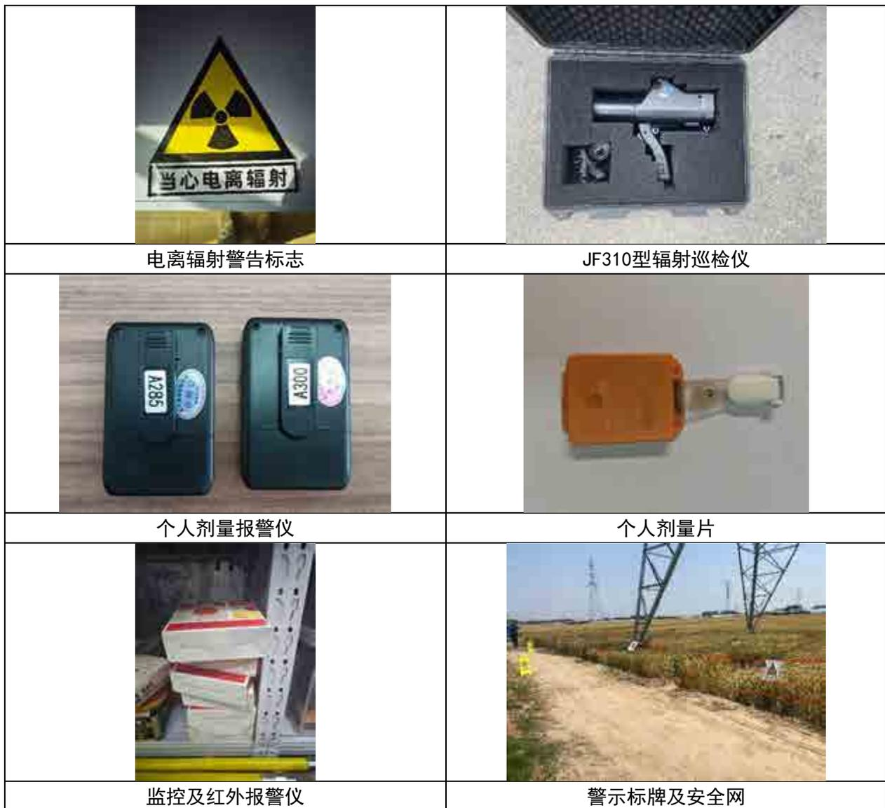
图 3-1 X 射线探伤机、安全设施及措施照片
