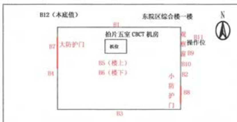
东院区放射科拍片五室 ProMax 3D 型 CBCT 机房周围检测布点示意图
