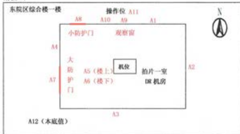
东院区拍片一室 Digital Diagnost(双)型 DR 机房周围检测布点示意图
