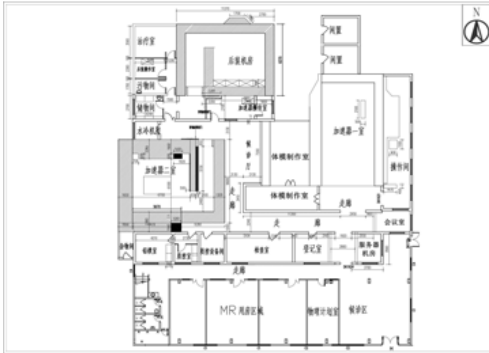
图 2-2 放疗室一层总平面布置图
