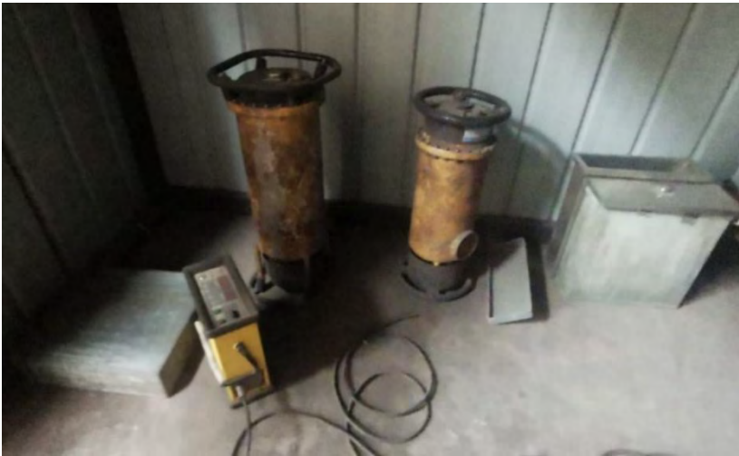
图 7-2 X 射线探伤机外型
