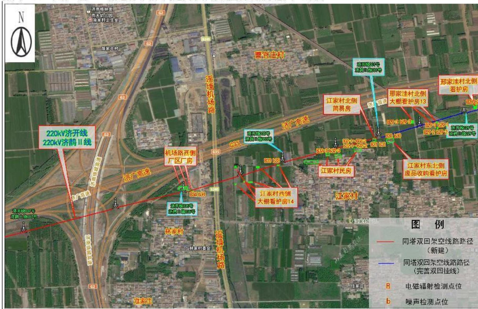
附图2 (e) 本期工程220kV输电线路路径周边关系影像及监测布点示意图 比例尺 1:22700
