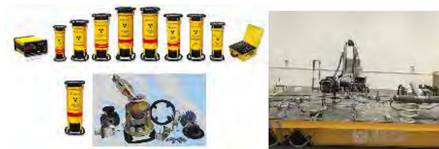
图 2-3 典型 X 射线探伤机外型及内部结构
