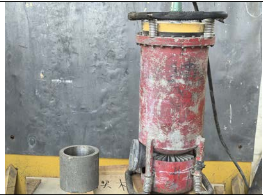
现场模拟探伤常用工件
