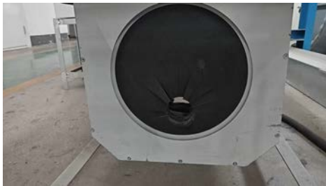
X 射线实时成像检测系统防护管道铅帘
